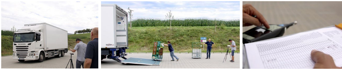
Abbildung 29: Lärmmessung durch vereidigten Sachverständigen (Messung bei alltagstypischen Be- und Entladevorgängen im August 2017)
